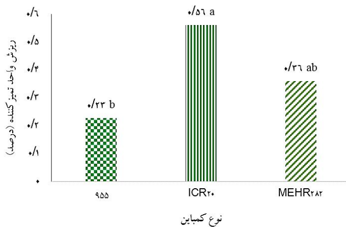
شکل ۸- ریزش واحد تمیزکننده تحت تأثیر نوع کمباین.
